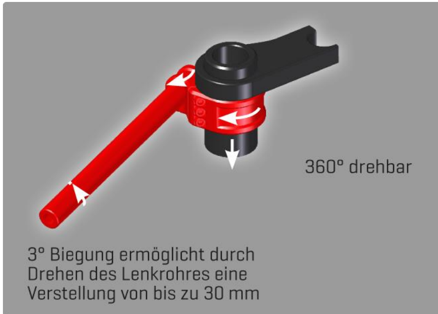
Bild 7: Einstellmöglichkeiten Stummel-Version „raceClip“
