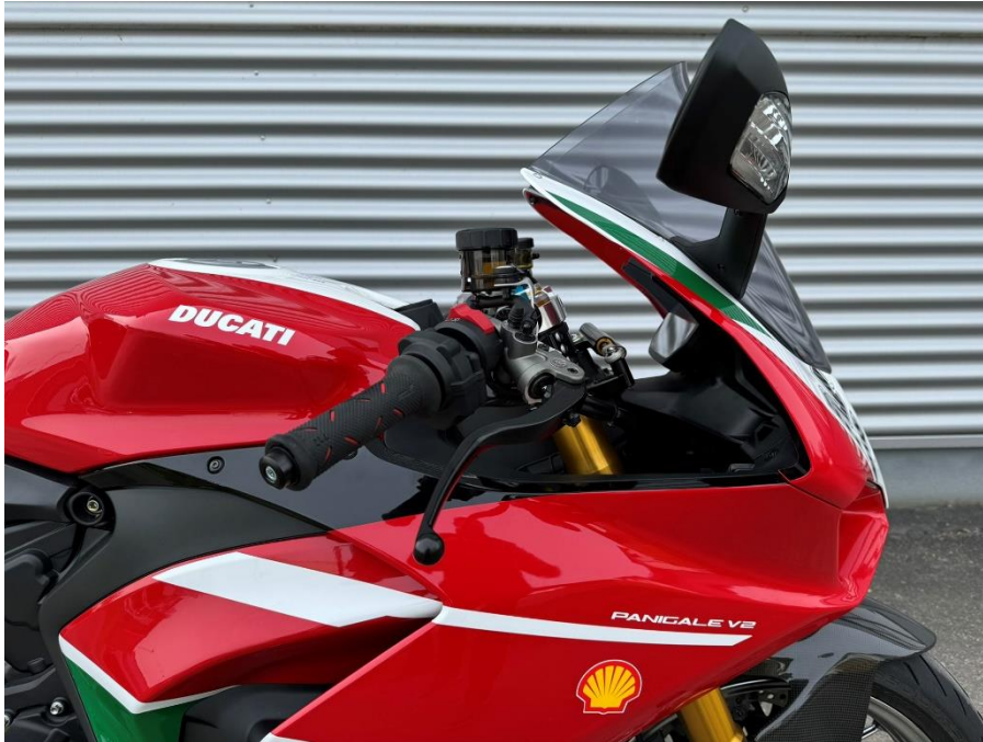
Bild 3: Lenkerposition kann durch den Umbau mit dem multiClip „Sport“ bis zu 3,5 cm erhöht werden
