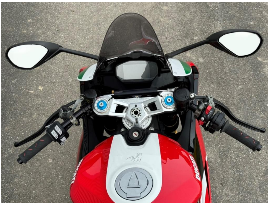
Bild 2: Lenker legt nach dem Umbau mit dem multiClip „Sport“ insgesamt um ca. 6 cm in der Breite zu
