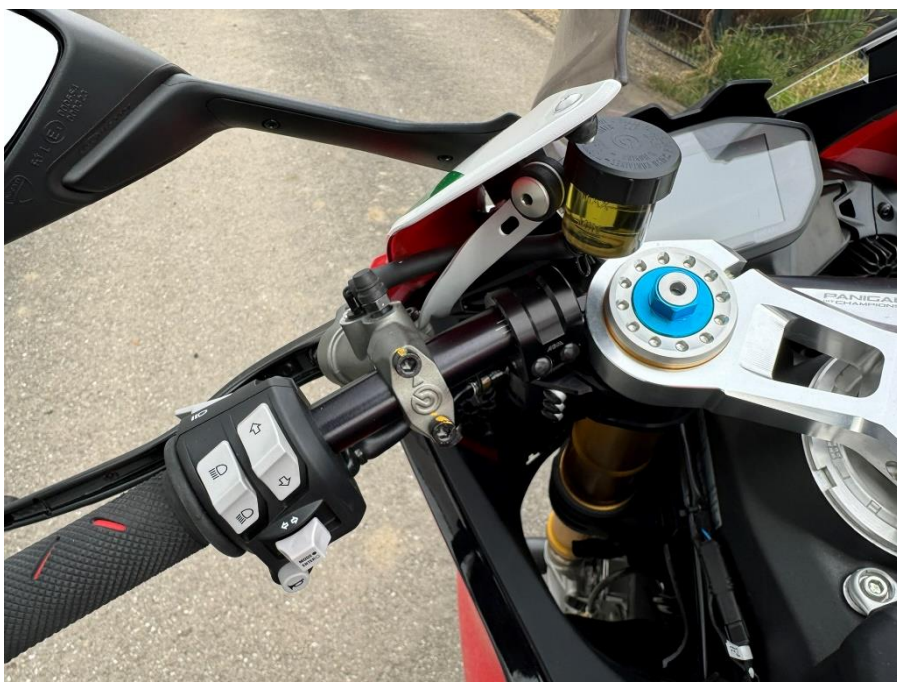
Bild 4: Stummellenrohr mit stufenloser Feinjustierung
